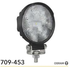
**9W - 1140LM - 6 DIODES - FLOOD 90°** 4,2" 10-30 V DC 0,75A@12V / 0,375A@24V
